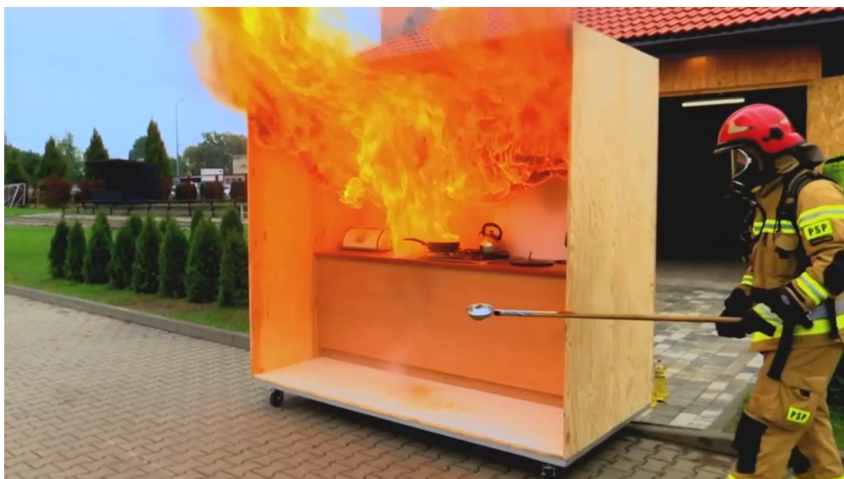
Rysunek 4.16 Stanowisko demonstracyjne zjawiska wyrzutu.
