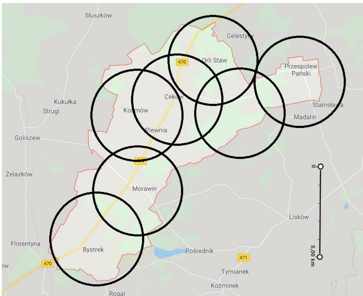
Rysunek 4.7 Mapka z planowanym rozmieszczeniem syren elektronicznych na terenie gminy Ceków-Kolonia.
