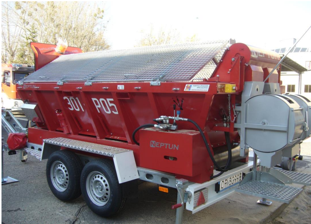
Rysunek 4.23 Przykładowe urządzenie do napełniania worków przeciwpowodziowych.
