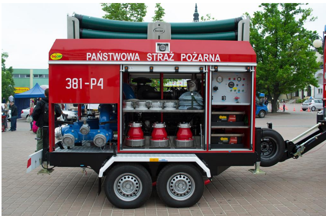
Rysunek 4.25 Przykładowa pompa dużej wydajności do wody zanieczyszczonej.
