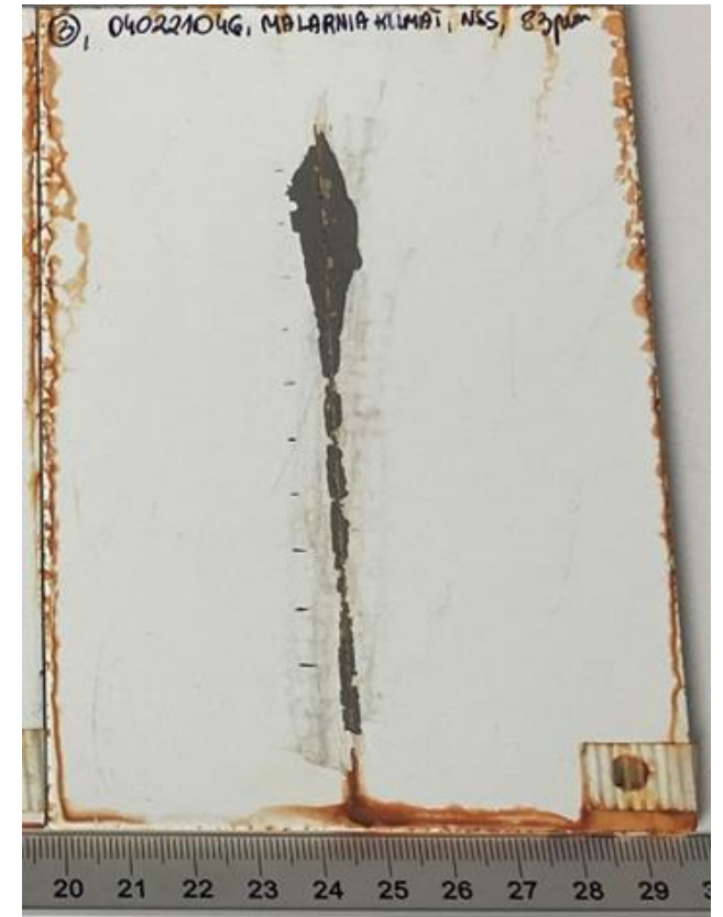
Próbka po badaniach w komorze solnej
