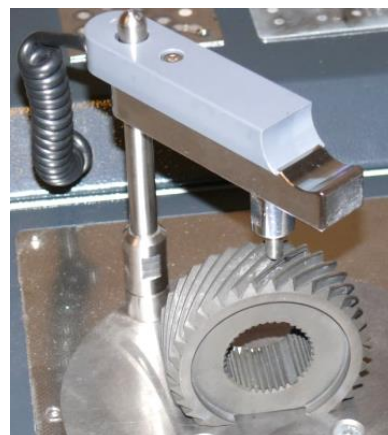
Rys. 40. Badanie składu chemicznego materiału koła zębatego walcowego
