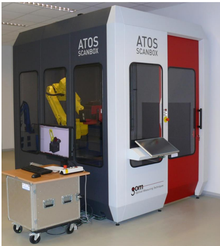
Rys. 13. Atos Scan Box 5108 firmy GOM GmbH
