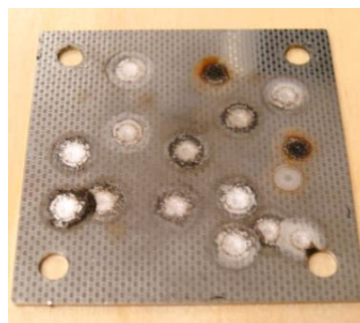
Rys. 41. Ślady powstałe po badaniu składu chemicznego blachy
