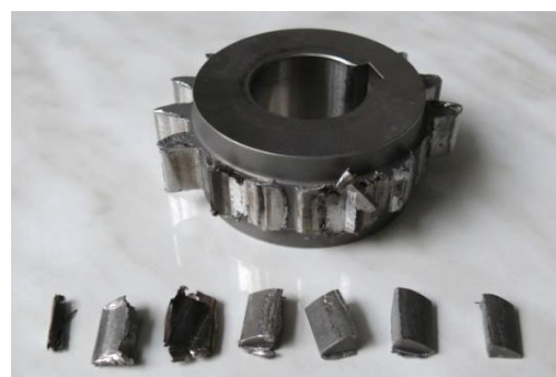
Rys. 29. Wyłamane zęby koła zębatego walcowego o zębatach prostych po teście wytrzymałościowym
