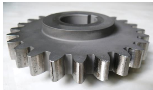
Rys. 28. Ślady zużycia koła zębatego walcowego o zębatach prostych po teście wytrzymałościowym
