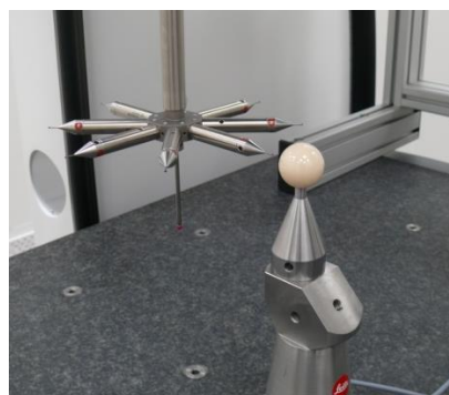
Rys. 11. Kalibracja na kuli wzorcowej
