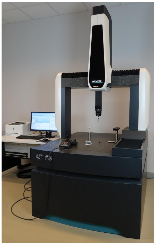
Rys. 7. Współrzędnościowa maszyna pomiarowa Wenzel LH 65
