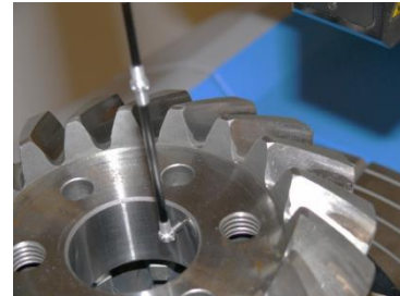
Rys. 2. Pomiar okrągłości otworu centralnego koła zębatego stożkowego o zębach łukowych
