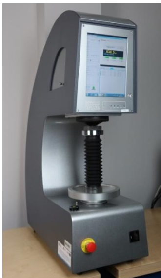
Rys. 37. Twardościomierz uniwersalny OMNITEST firmy ERNST
