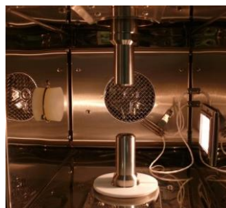
Rys. 31. Wnętrze komory termicznej
