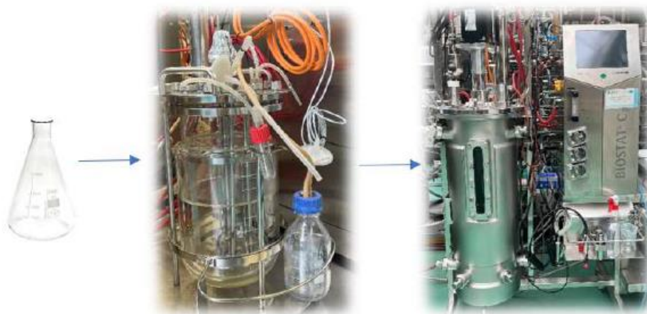
Rysunek 17. Schemat etapów biosyntezy kwasu alfa-ketoglutowego
