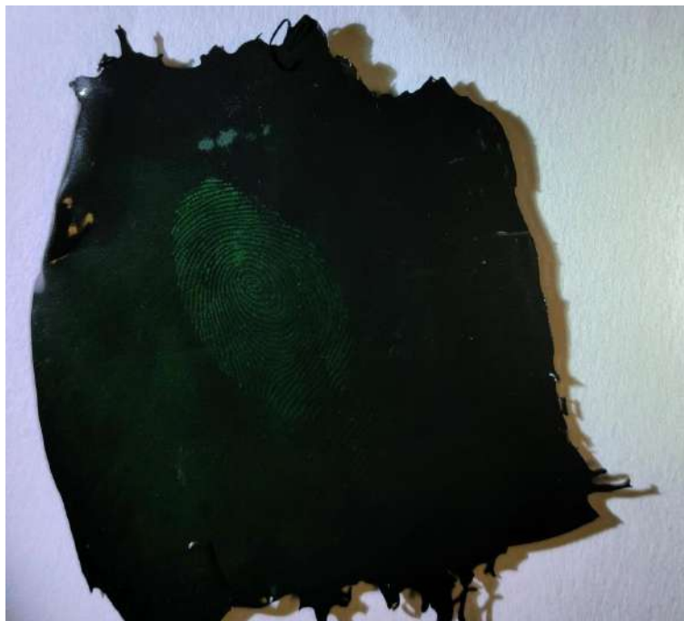
Zdjęcie 11. Zabezpieczony fragment odwzorowania linii papilarnych (ujawniony proszkiem fluorescencyjnym) w masie silikonowej.
