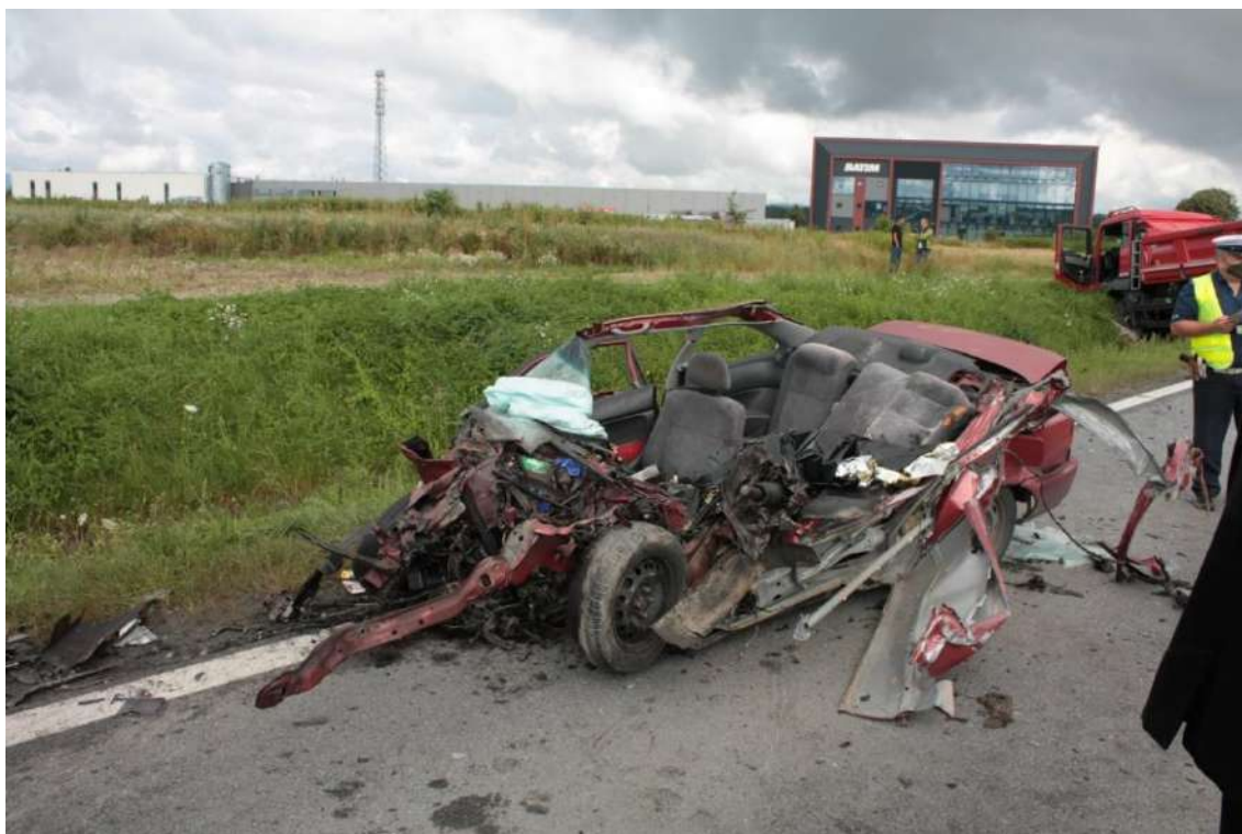
Zdjęcie 32. Odcięte fragmenty karoserii pojazdu podczas akcji ratunkowej, umożliwiające dostanie się do zakleszczonych w pojeździe ofiar.
