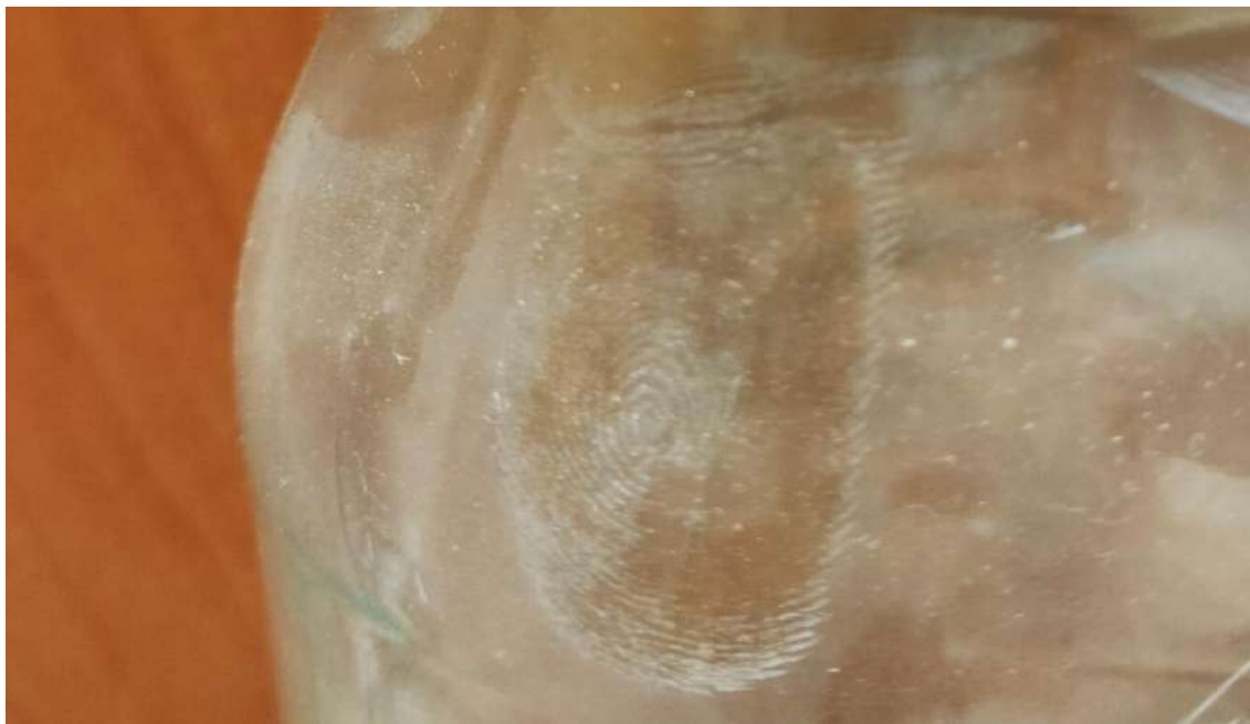
Zdjęcie 9. Ślad daktyloskopijny ujawniony metodą cyjanoakrylową.
