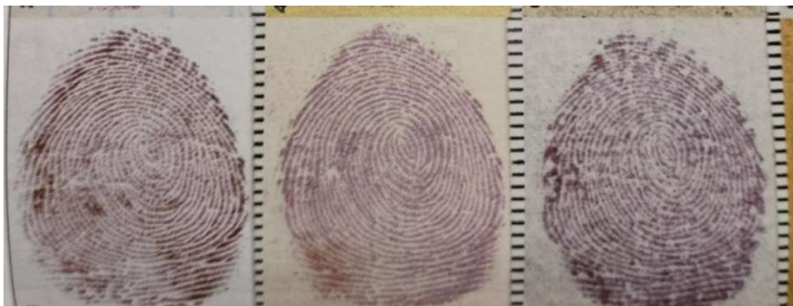
Zdjęcie 8. Linie papilarne na papierze ujawnione za pomocą ninhydryny.
