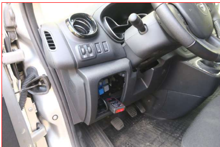
Rysunek. 2.34 Podłączenie poprzez interfejs diagnostyczny urządzenia firmy
