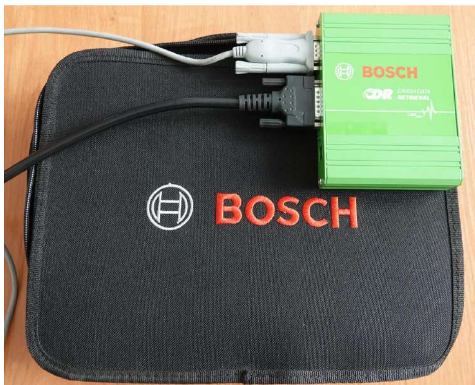
Rysunek.2.21. Urządzenie CDR CANplus
