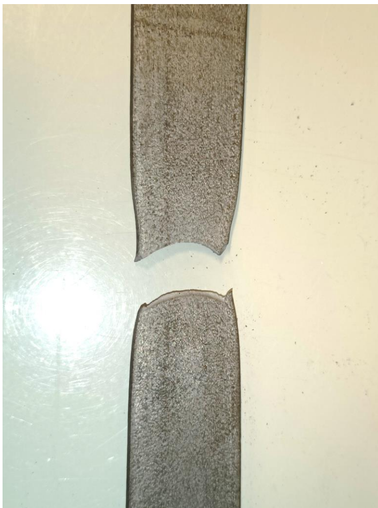
Rys. 25 Miejsce zerwania które służy do obliczeń a_u i b_u . Grubość i szerokość po zerwaniu
