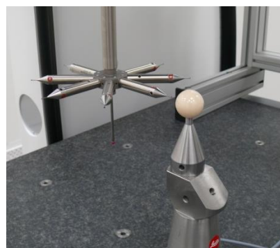
Rys. 11. Kalibracja na kuli wzorcowej
