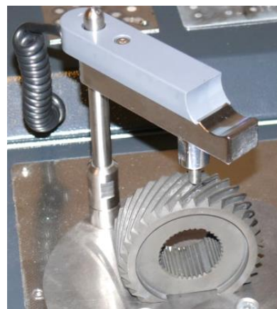
Rys. 36. Badanie składu chemicznego materiału koła zębatego walcowego
