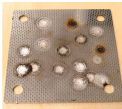
Rys. 37. Ślady powstałe po badaniu składu chemicznego blachy
