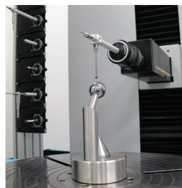
Rys. 22. Kalibracja na kuli wzorcowej
