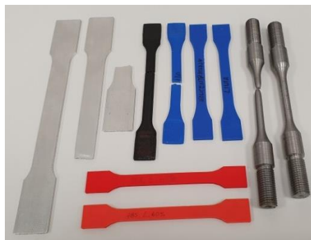
Rys. 32. Przykładowe próbki do statycznej próby rozciągania
