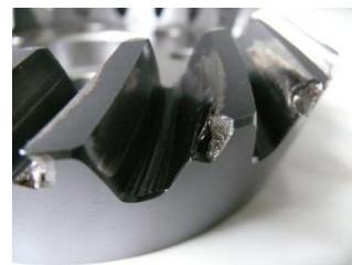
Rys. 25. Wykruszenia zębów koła zębatego stożkowego o zębach łukowych
