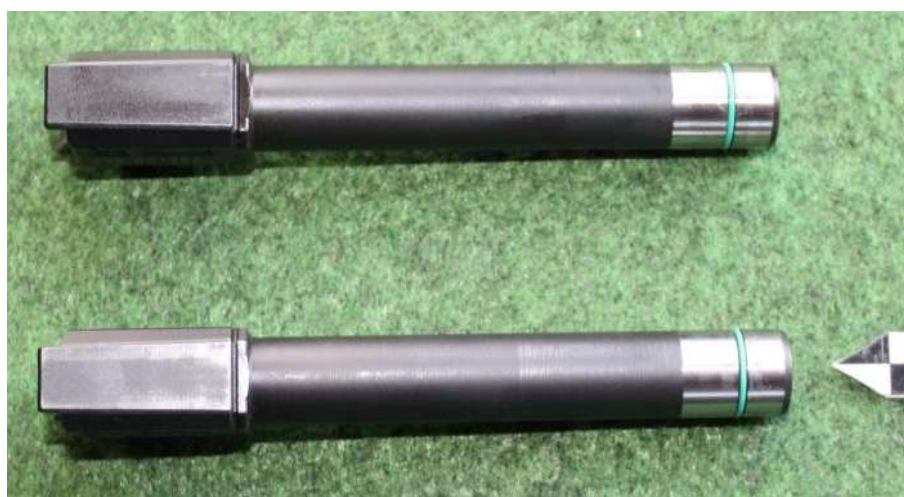
Fot. 19. Widok lufy od strony grzbietowej broni używanej nr 239-000339 (oznaczona strzałką) – powyżej lufa nowa z egzemplarza o numerze 239-001754
