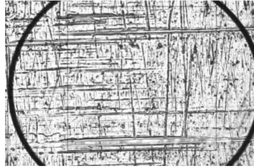
b. Struktura materiału części używanej – położenie przedmiotu w pozycji 0°, powiększenie 500x.
