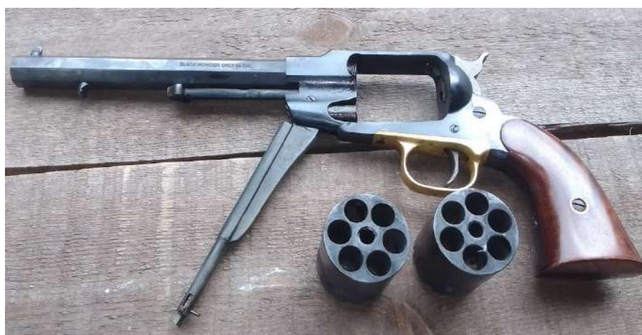
Fot. 27. Badany rewolwer Remington 1858 New Army .44 w stanie rozłożonym
