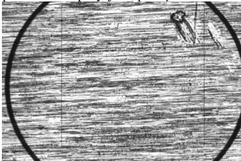
c. Struktura materiału części używanej – położenie przedmiotu w pozycji 90°, powiększenie 100x.
