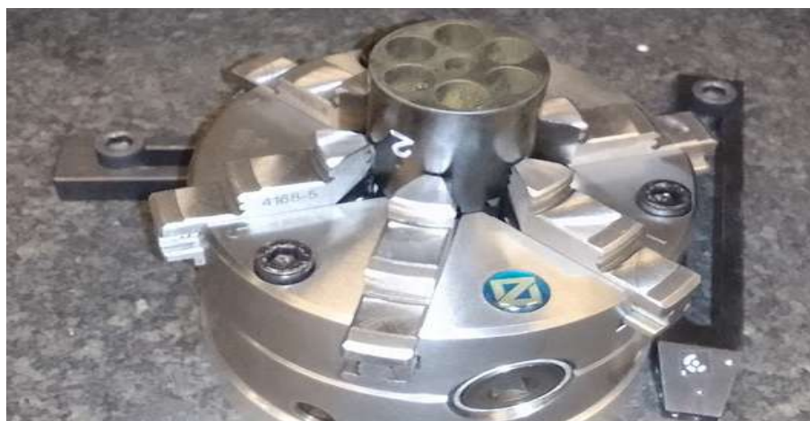
Fot. 32. Pomiar komór nabojoych w bębnie za pomocą urządzenia Wenzel LH65
