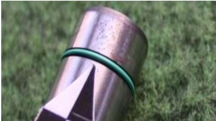
Fot. 16. Miejsca na lufie broni nr 239-000339 pokryte siatką korozji
