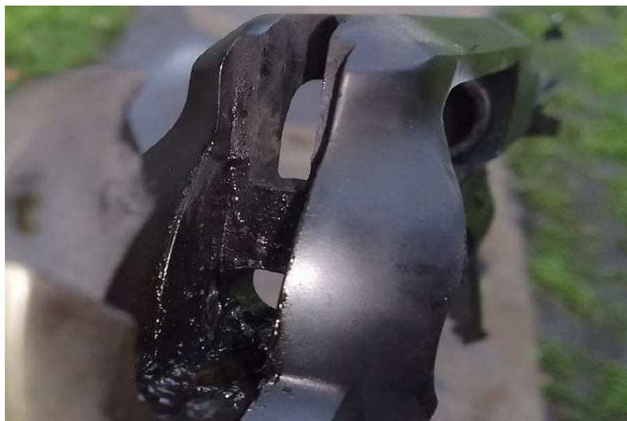
Fot. 28. Nagromadzony nagar w okolicy kurka po wystrzeleniu 24 nabojów w broni Remington 1858 New Army .44
