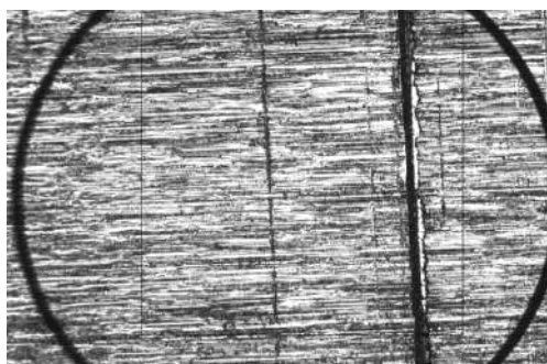
c. Struktura materiału części nowej – położenie przedmiotu w pozycji 90°, powiększenie 100x.
