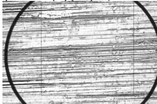
d. Struktura materiału części używanej – położenie przedmiotu w pozycji 90°, powiększenie 500x.
